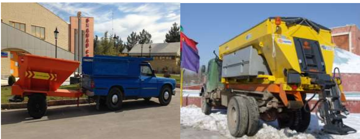
شکل ۳- خودروهای مکانیزه مجهز به دستگاه نمک‌پاش: الف) پلاگین، ب) کششی
