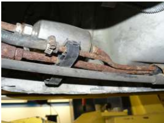
شکل ۱۰- پوسیدگی اجزای خودرو
